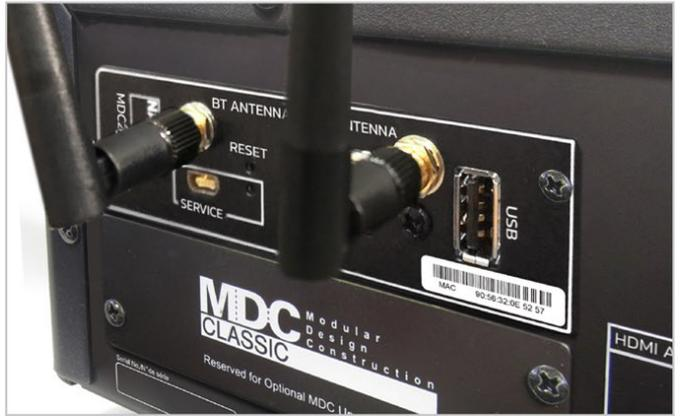
Schließen Sie die mitgelieferte Bluetooth-Antenne und die WLAN-Antenne an\*
